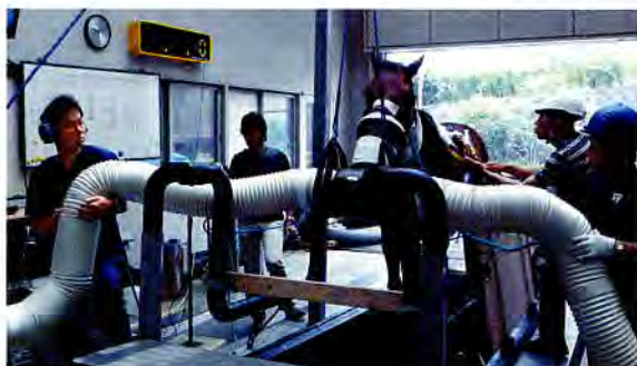
図5 オープンフローシステム
