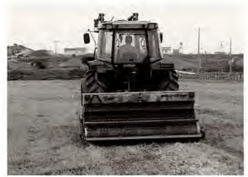
図3 簡易更新機 追播、不耕起更新が可能となります。
