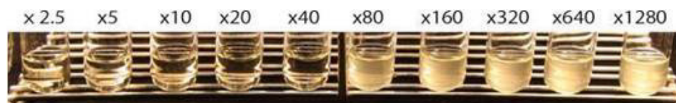
図7 逆性せっけん消毒剤(ヒビテン ® )の臨床分離細菌株( S. aureus )に対する殺菌能 希釈倍率は左から2.5万倍~1280万倍までハートインフュージョン培地にて2倍段階希釈。右端はコントロール。 in vitro では40万倍希釈溶液まで発育阻止能が認められた。
